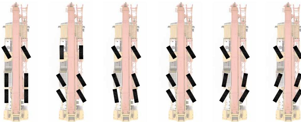
Independent front axle steering 后桥锁定转向模式
